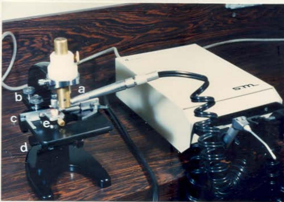
Figura 1 - Microscópio adaptado para o preparo cavitário.
