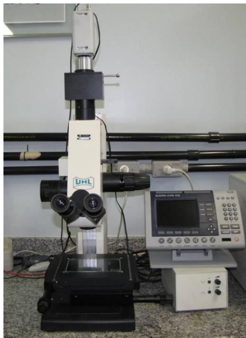
Figura 19– Microscópio comparador 3D computadorizado (Mikro Vision; Leica, Alemanha).
