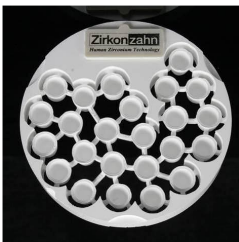
Figura 17 – Bloco de zircônia após a fresagem.
