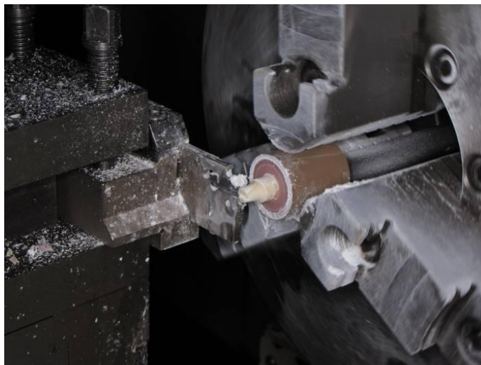
Figura 7 – Preparo do dente em torno mecânico.
