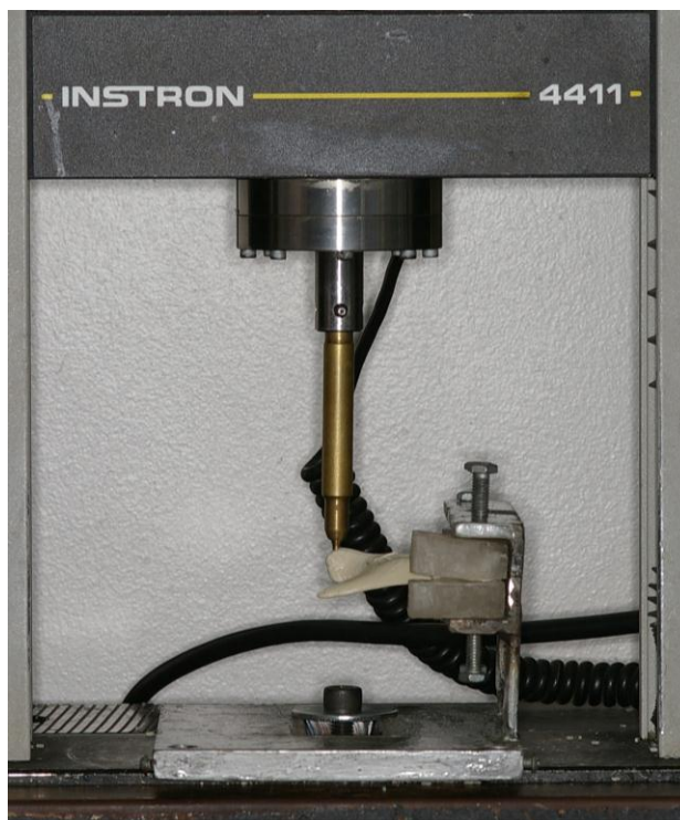
Figura 17 – Suporte para teste médio-lateral instalado na máquina.
