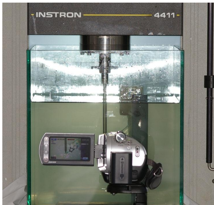
Figura 27 - Vista frontal do polariscópio acoplado à máquina de ensaio Instron, durante teste de carregamento e análise fotoelástica.
