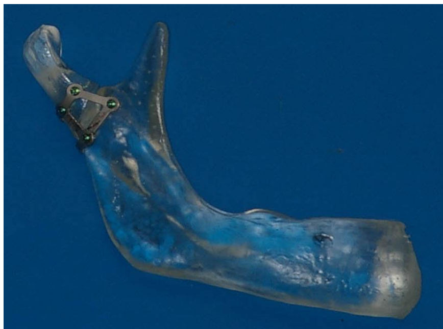
Figura 25 – Hemimandíbula em resina fotoelástica fixada com placa trapezoidal com extensão do sistema 1,5mm.
