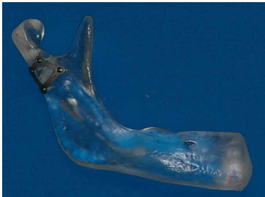
Figura 24 – Hemimandíbula em resina fotoelástica fixada com placa trapezoidal do sistema 1,5mm.
