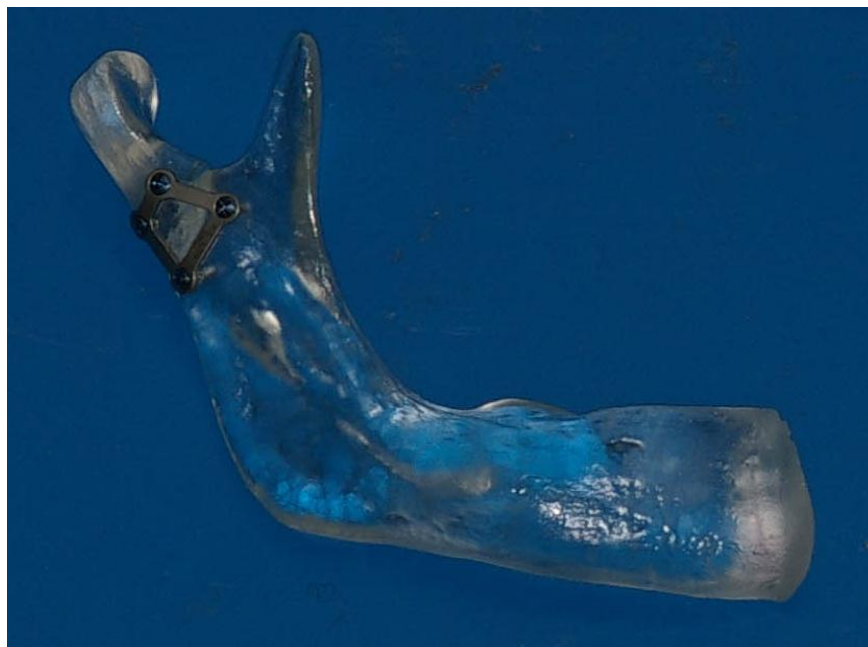
Figura 22 – Hemimandíbula em resina fotoelástica fixada com placa trapezoidal do sistema 2,0mm.
