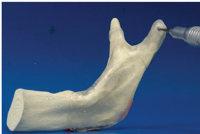
Figura 9 – Guia para redução e preparo do ponto de aplicação de carga.
