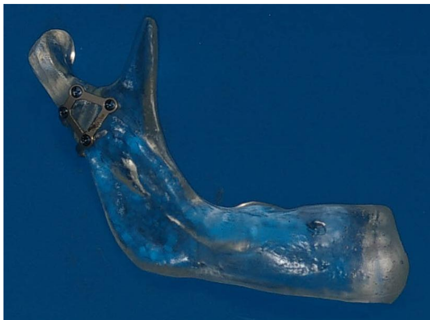
Figura 23 – Hemimandíbula em resina fotoelástica fixada com placa trapezoidal com extensão do sistema 2,0mm.
