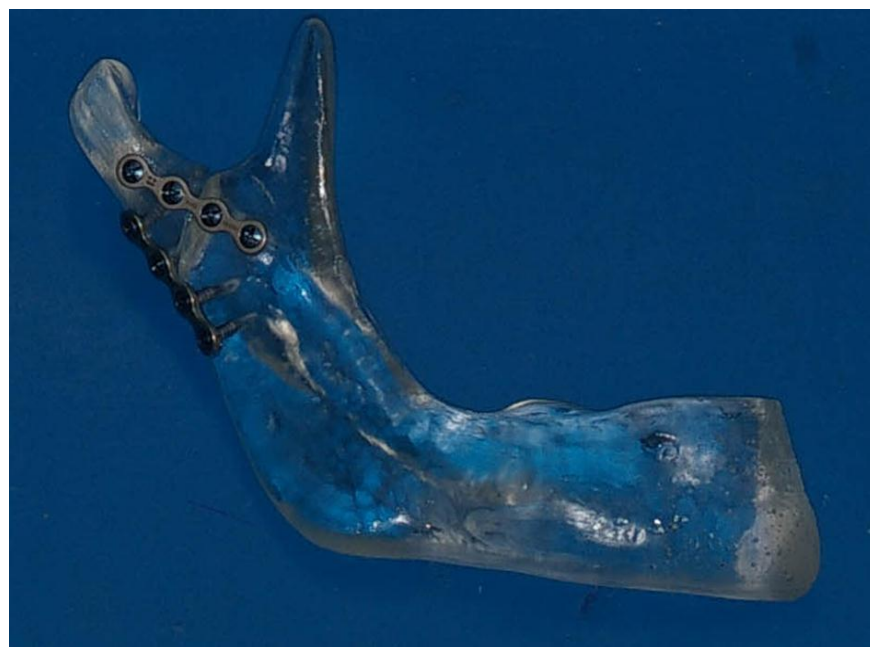
Figura 21 – Hemimandíbula em resina fotoelástica fixada com 2 placas retas do sistema 2,0mm.
