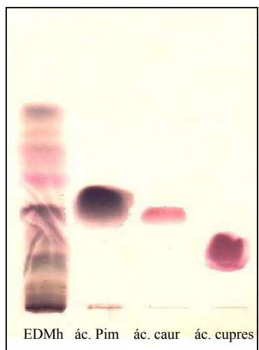
FIGURA 24 – CCD da comparação entre o EDMh, ácido diterpênico isolado da M. hirsutissima (ác. Pim), ácido caurenóico (ác. caur) e ácido cupressênico (ác. cupres). Placa impregnada com solução de \text{AgNO}_3 1%, eluída com hexano:acetato de etila 80:20 e revelada com solução de anisaldeído.
