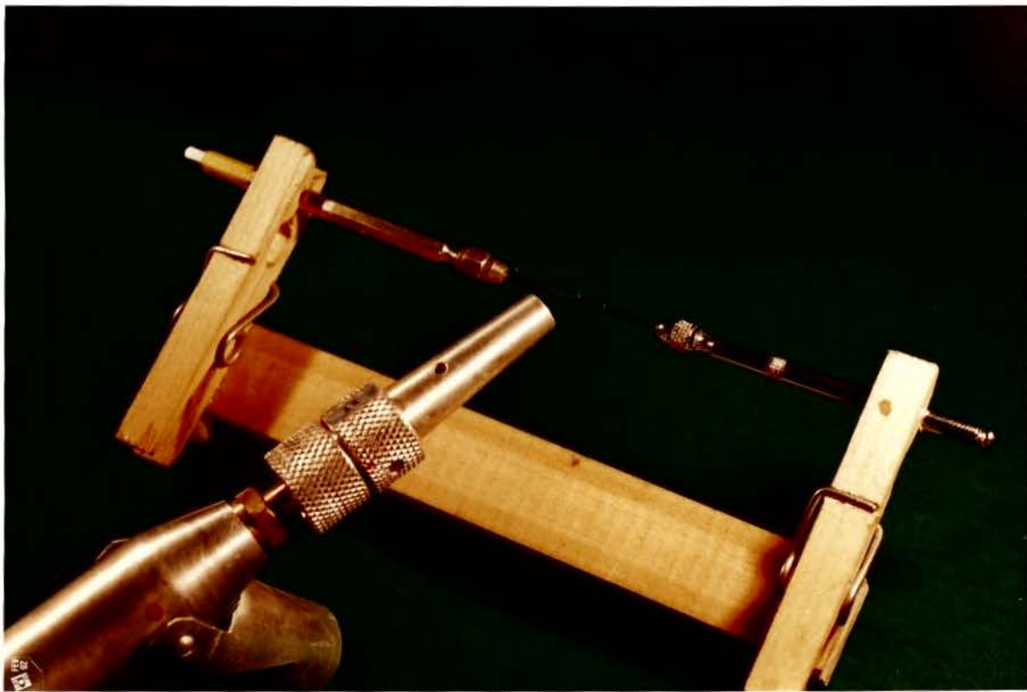
Figura 4.4 - Maçarico para soldagem gás-ar tipo Miniflam, marca Metalvander; suporte idealizado para imobilizar as porta-sondas lisas durante à soldagem
