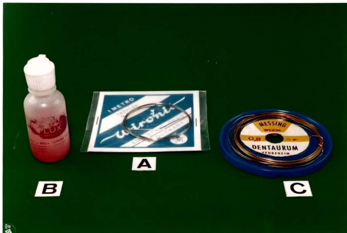
Figura 4.2 - Fio de aço inoxidável (A), fluxo (B) e fio de latão (C) em suas respectivas embalagens comerciais.
