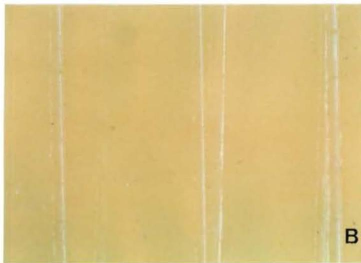
Figura 7.4 - Fotomicrografia da sílica por adição Extrude (A) e da sílica por condensação 3 M (B), após a separação da matriz e classificados nos graus 2 e 1, respectivamente.
