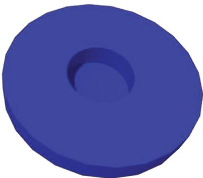
IV- Molde de silicone com formato circular com 5mm de diâmetro e 2mm de em espessura.
