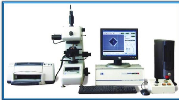
Figura 5: Microdurômetro Future Tech FM 9000-ARS
