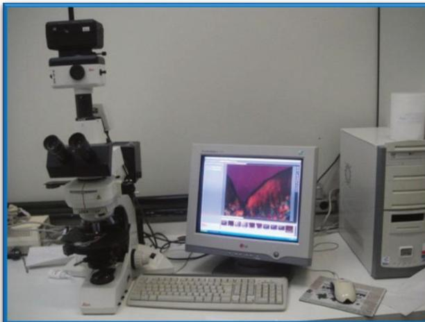
Figura 7: Microscópio de luz polarizada Leica DMLP (Leica Microsystems, Wetzlar, Alemanha) acoplado a um sistema digital Leica FFC 280 para obtenção de fotomicrografias com uma ampliação padrão de 5x.
