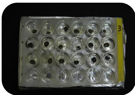
Figura 19. – Fatias imersas em solução foto-reveladora por 8h sob luz fluorescente para reduzir íons prata em grãos metálicos de prata dentro dos espaços vazios na interface adesiva.
