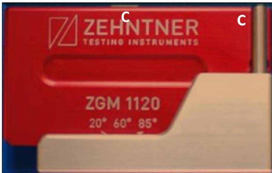
Figuras 3 – (C) Medidor de brilho acoplado ao calibrador.
