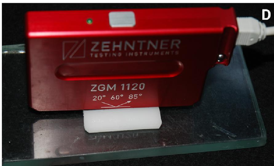
Figuras 3 – (D) Medidor de brilho sobre dispositivo e amostra.
