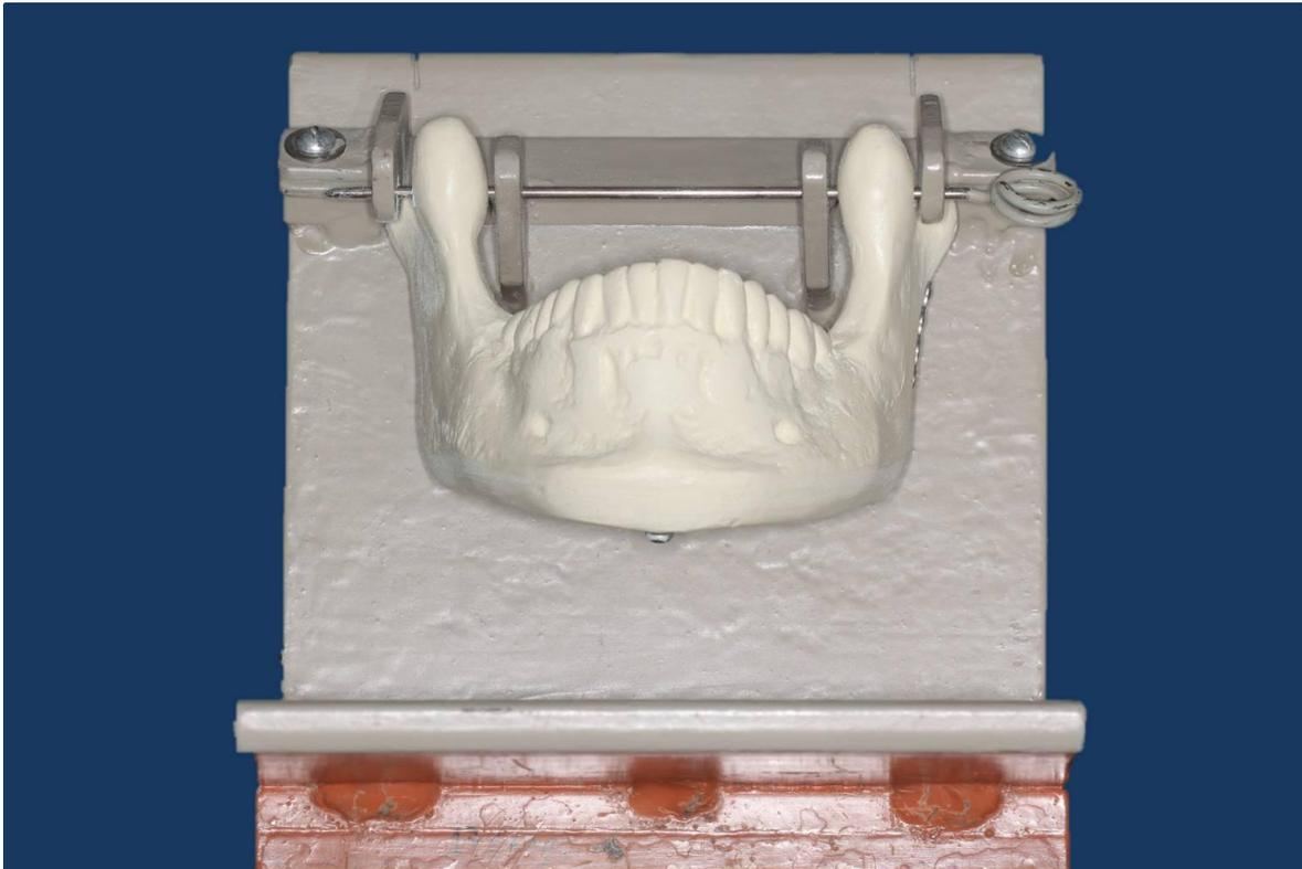
Figura 16 – Posicionamento da mandíbula de poliuretano no suporte de testes, sendo os côndilos estabilizados na região posterior e os coronóides como eixo de rotação.
