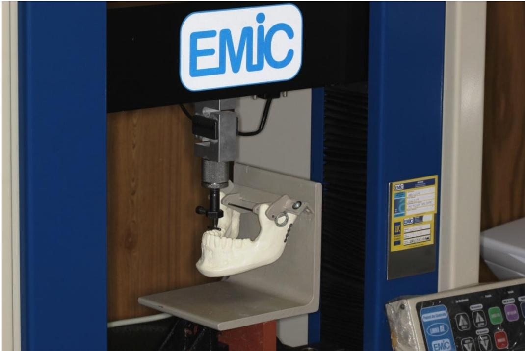
Figura 17 – Aplicação de carga na máquina de ensaios EMIC, modelo DL2000.
