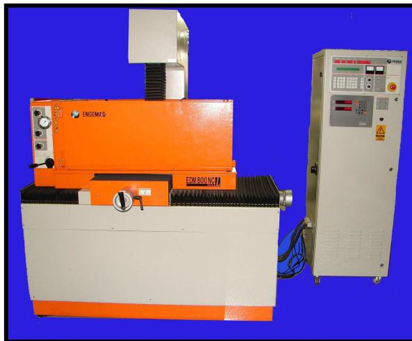
**Figura 18** - Máquina de Eletroerosão.
