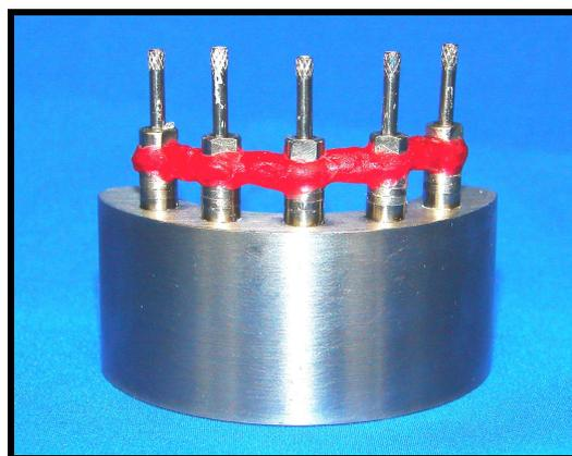
**Figura 2:** Transferentes quadrados unidos com resina acrílica.
