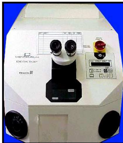
**Figura13** – Máquina de soldagem a laser.
