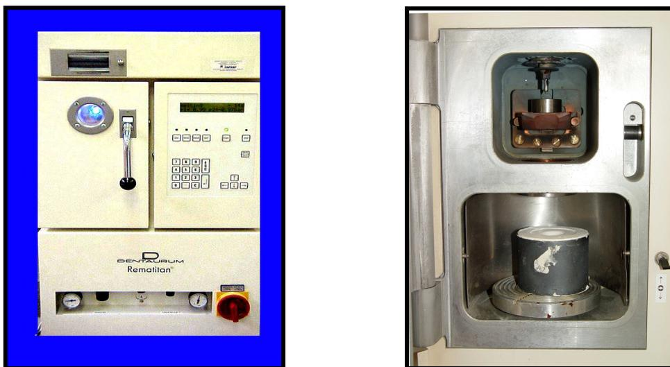
**Figura 10 - Máquina de fundição**
