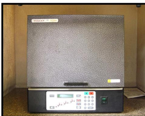
**Figura 9** - Forno de pré-aquecimento.
