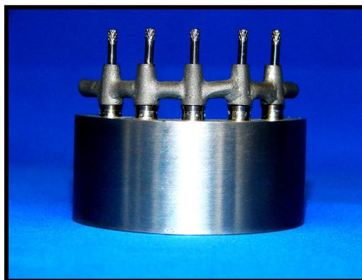
**Figura11** - Infra-estrutura fundida e posicionada sobre a matriz metálica.
