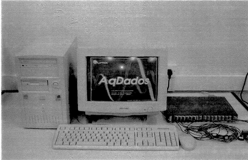
**Figura 1** Microcomputador 486DX, tela inicial do *software* AqDados e módulo condicionador de sinais analógicos.
