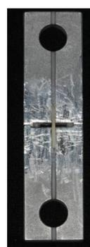
Figura 9 – Posicionamento do palito no dispositivo para o teste de microtração.
