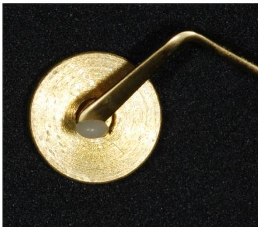
Figura 10 – Inserção da resina composta na matriz metálica.
