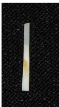
Figura 8 – Palito selecionado para realização do teste de microtração.
