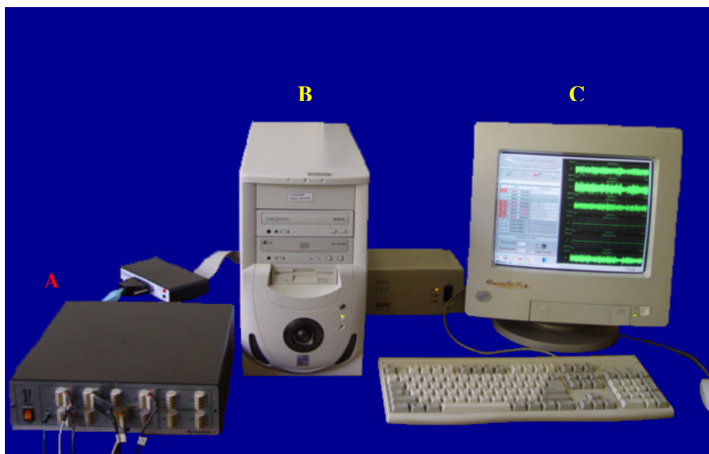
Figura 1- Eletromiógrafo (A), microcomputador com placa de conversor A/D instalada (B) e tela do monitor mostrando a aquisição do sinal eletromiográfico por meio do software (C).
