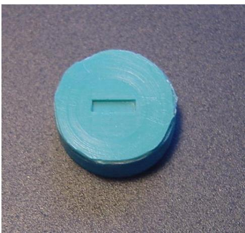
Figura 7. Matriz de silicona para confecção de corpos de prova. Dimensão de 5mm x 2mm x 1mm.
