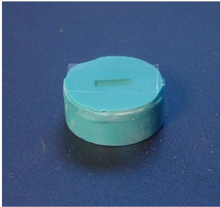
Figura 9. Após aplicação dos materiais resinosos na matriz, posicionamento da tira de poliéster.
