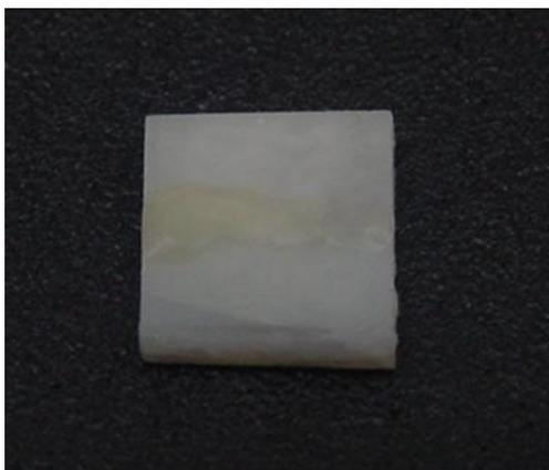
Figura 24. Corpo de prova de esmalte bovino cariado após aplicação de cera pegajosa, dividindo-a em duas partes.
