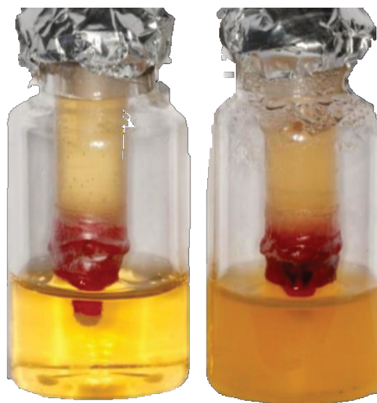
Figura 9: Dispositivo da esquerda sem turvação do meio e dispositivo da direita apresentando turvação do BHI, indicando infiltração bacteriana.
