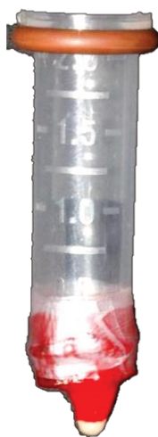
Figura 4: Anéis de borracha do tipo o-ring inseridos na parte superior dos tubos de polipropileno, para auxiliar uma melhor adaptação dos tubos ao frasco de vidro.
