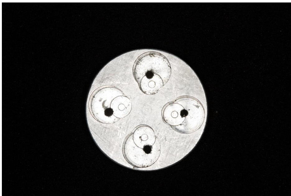
Figura 5: Porta-espécimes múltiplo com quatro células desenvolvido por Aragão (2010).
