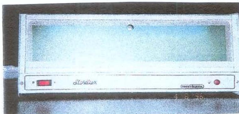
Figura 3: Câmara de ultravioleta.
