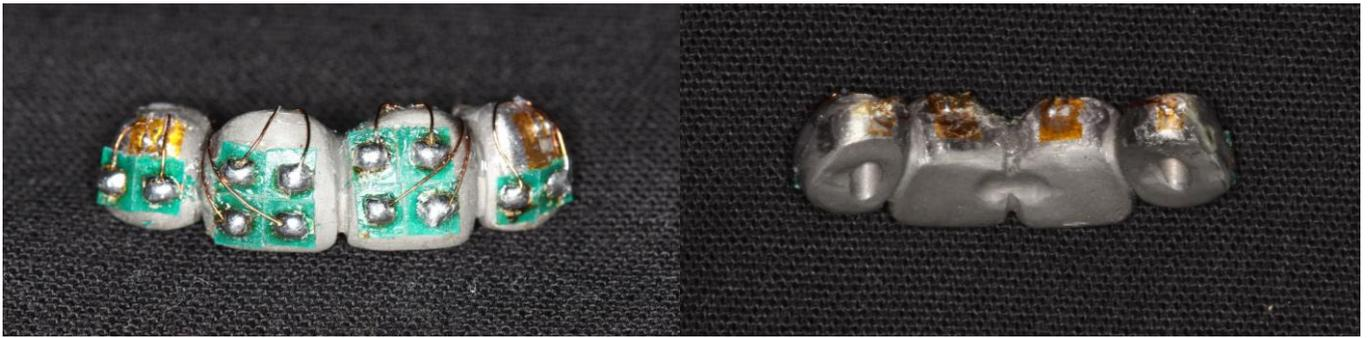
Figura 11 – b) Extensômetros posicionados na face vestibular (esquerda) e palatina (direita) da infraestrutura I.
