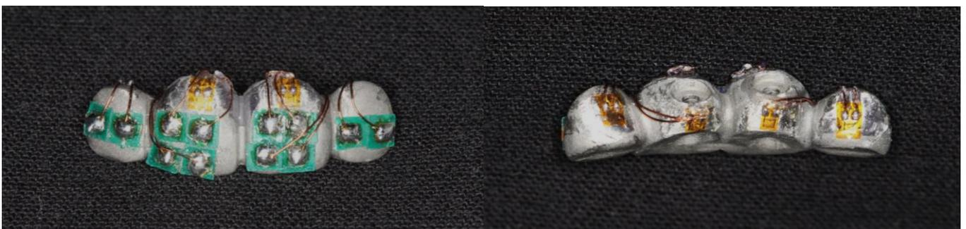
Figura 11 – c) Extensômetros posicionados na face vestibular (esquerda) e palatina (direita) da infraestrutura II.
