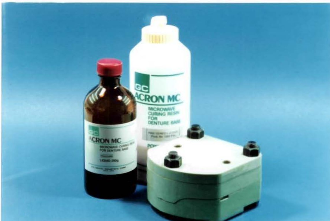
Fig.3: Resina Acrílica e mufla especiais para polimerização através de energia de microondas utilizadas no estudo.
