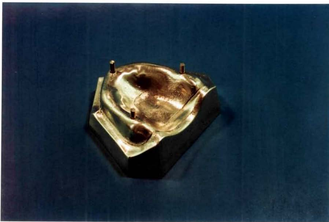
Fig.1: Modelo mestre metálico simulando uma maxila edêntula utilizado no estudo.
