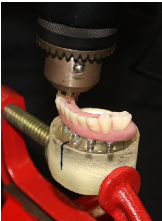
Figura 10. Os modelos índex foram fixados em bancada com grampo metálico, para realização do aperto dos parafusos
