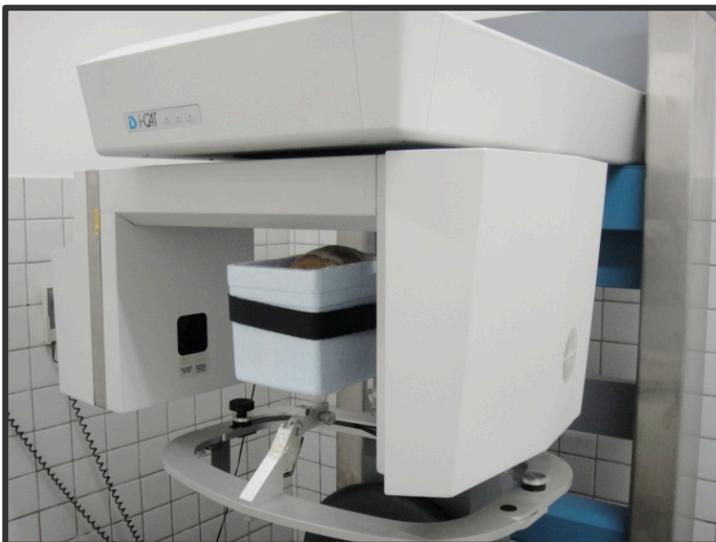
Figura 5 - Posicionamento da mandíbula e crânio no interior da caixa de isopor com água, para a aquisição de imagem no aparelho de tomografia *Cone Beam i-Cat*.
