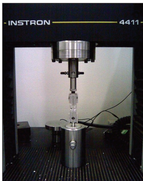
Figura 4 – Dispositivo de Geraldelli posicionado nos braços de suporte fixados na máquina de ensaio de tração universal para realização do ensaio de tração.
