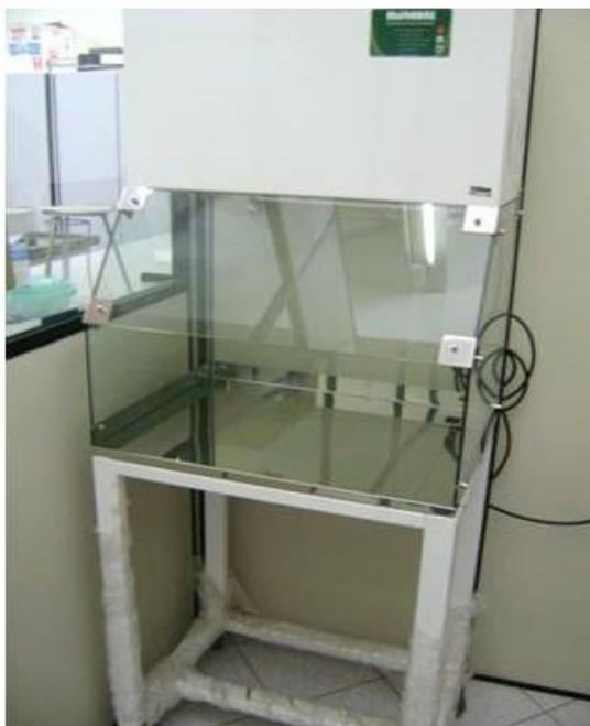
**Figura 4.5: Capela de fluxo laminar**
