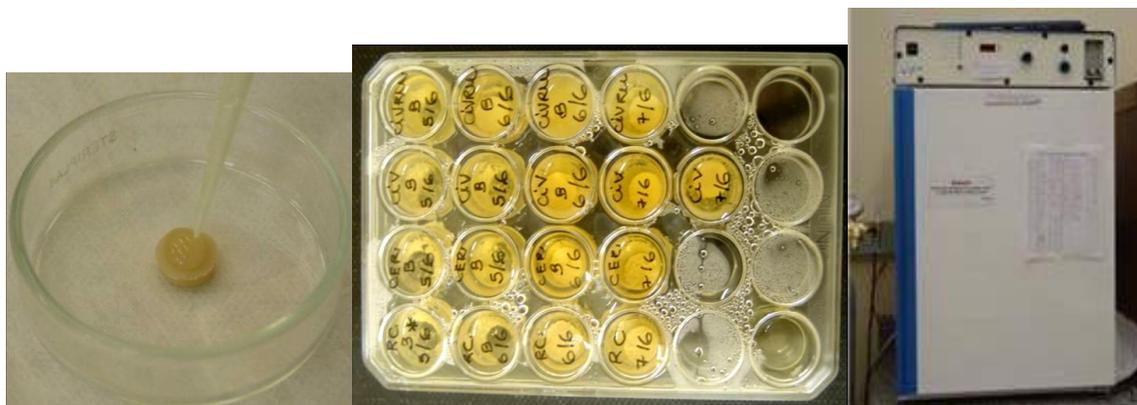
Figura 4.7: Desenvolvimento do biofilme: A. Inóculo de 20 µL sobre a superfície do material para adesão inicial de células B. Placa de cultura de 24 poços contendo o disco com o biofilme aderido imerso em meio de BHI com 1% sacarose. Troca do meio a cada 48 horas. C. Estufa de CO<sub>2</sub>, na qual as amostras foram armazenadas
