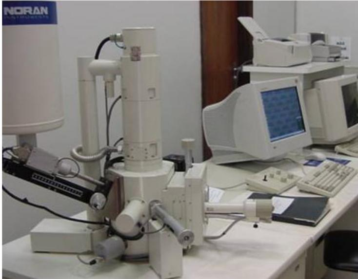
**Figura 4.11: Microscópio Eletrônico de Varredura**
