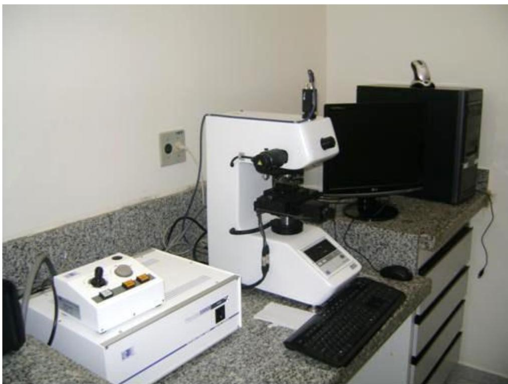
**Figura 4.9: Microdurômetro Future-Tech**
