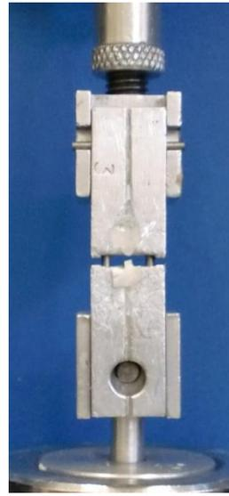
**Figura 12.** Amostra fraturada após o teste de microtração.
