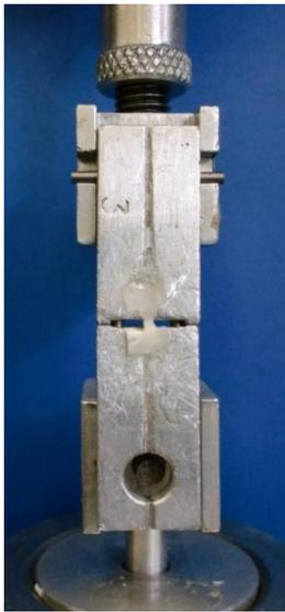
**Figura 11.** Amostra fixada com Super Bonder Gel ao dispositivo de microtração.
