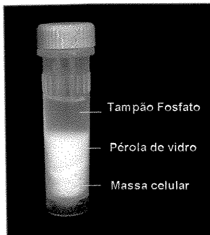
Figura 2 - Tubo plástico com rosca (2mL) empregado na extração de proteínas de Streptococcus mutans . Tampão Fosfato ( \approx 250\mu\text{L} ); pérola de vidro ( \approx 500\text{mg} ); massa celular ( \approx 500\text{mg} ).
