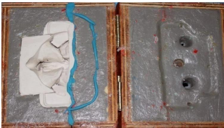
Figura 4 – Molde de silicone leve e contra molde de material de isolamento térmico utilizados para confeccionar a porção superior do crânio em resina fotoelástica. A massa azul é composta de modeline para evitar o escape de resina. O extravasamento de resina ao se fechar a caixa sob pressão ocorreu através das perfurações em sua tampa.
