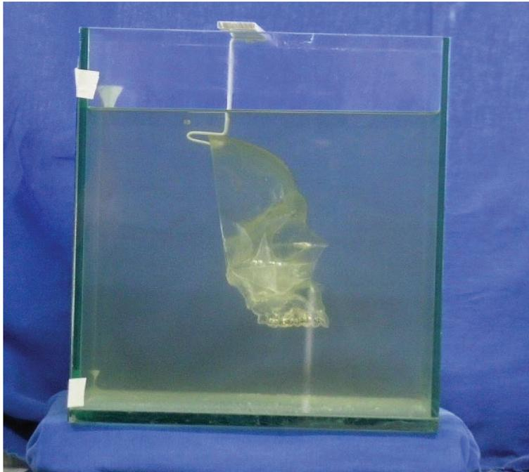
Figura 14 – Haste de alumínio confeccionada para suportar os crânios e permitir análise frontal, frontal inclinada e perfil 3/4.
