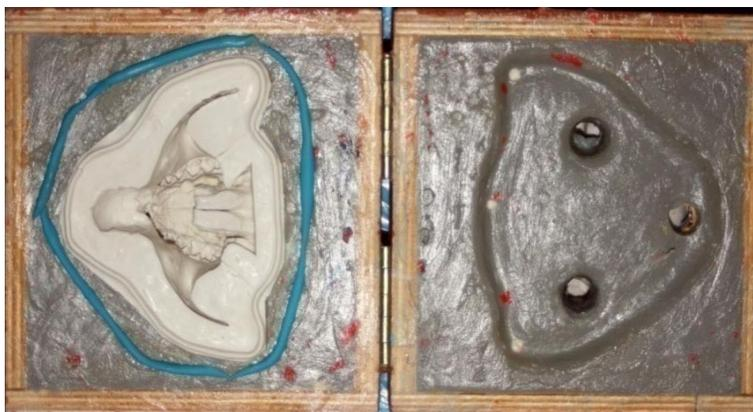
Figura 3 – Molde de silicone leve e contra molde de material de isolamento térmico utilizados para confeccionar a porção inferior do crânio em resina fotoelástica. A massa azul é composta de modeline para evitar o escape de resina. O extravasamento de resina ao se fechar a caixa sob pressão ocorreu através das perfurações em sua tampa.
