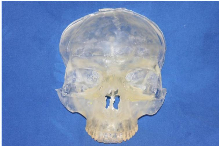
Figura 6 – Crânio de resina fotoelástica montado.
