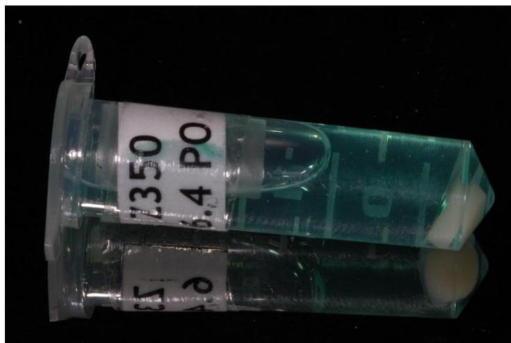
**Figura 11** – Corpo de prova imerso em 2ml de solução enxaguatória
