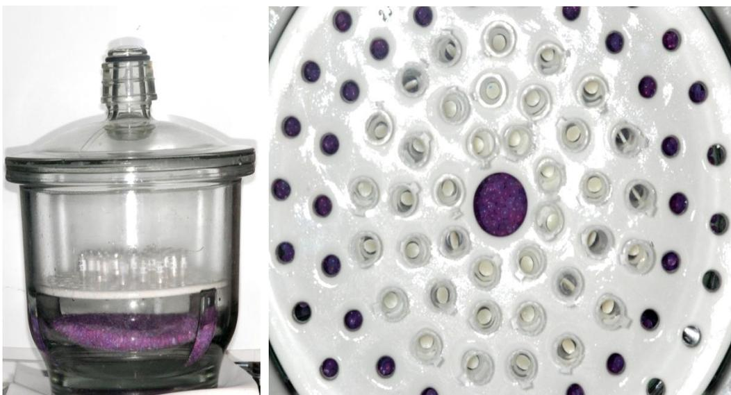
**Figuras 8** – Dissecador a vácuo contendo sílica gel e amostras armazenadas separadamente em *ependorfes*.
