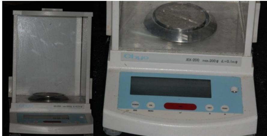
**Figuras 9** – Balança analítica digital Chyo JEX-200
