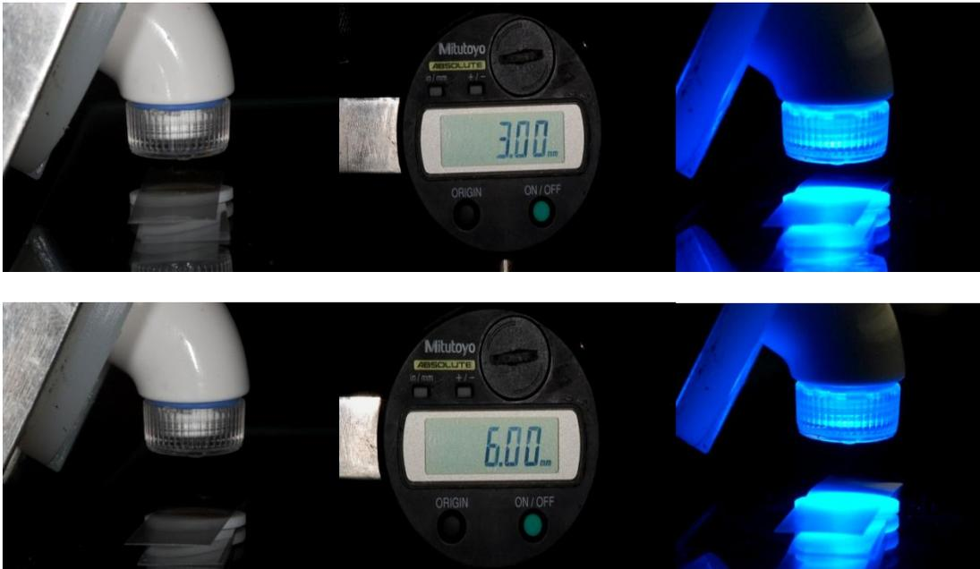
**Figuras 5:** **A** - Aparelho fotoativador LED FlashLite 1401 acoplado ao dispositivo, o qual deixava a ponta do aparelho perpendicular a superfície do compósito. **B** – Paquímetro digital acoplado ao dispositivo que controlava as distâncias de fotoativação testadas neste estudo (0mm, 3mm e 6mm). **C** - Fotoativação do compósito para cada distância testada durante 20 segundos conforme recomendações do fabricante
