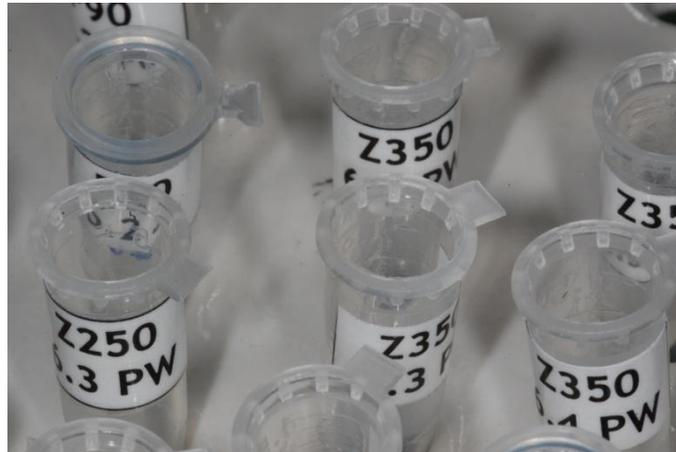
**Figura 12** – Corpos de prova dentro dos respectivos ependorfes e pesados periodicamente até a obtenção de uma massa constante após o período de sorção.
