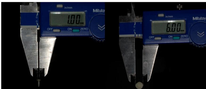
**Figura 10A** – Quatro aferições equidistantes da espessura dos corpos de prova através de um paquímetro digital. **B** – 4 aferições equidistantes do diâmetro dos corpos de prova
