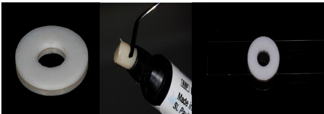
**Figura 2A** – Matriz de teflon 6mm de diâmetro e 1mm de profundidade; **B:** compósito nanoparticulado a ser inserido em incremento único; **C:** tira de poliéster e matriz de teflon colocadas sobre uma placa de vidro.
