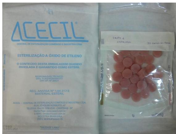
Figura 10 - Corpos-de-prova esterilizados com óxido de etileno.
