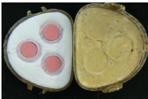
Figura 9 – Demuflagem dos corpos-de-prova.
