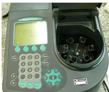
Figura 12 - Espectrofotômetro.
