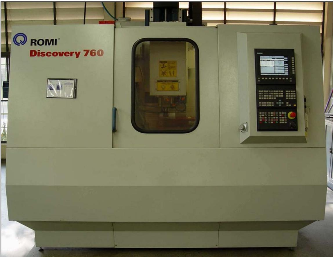
Figura 4 – Centro de usinagem utilizado para a confecção dos canais laterais nos dentes experimentais - localizado no Serviço Nacional de Aprendizagem Industrial (SENAI).
