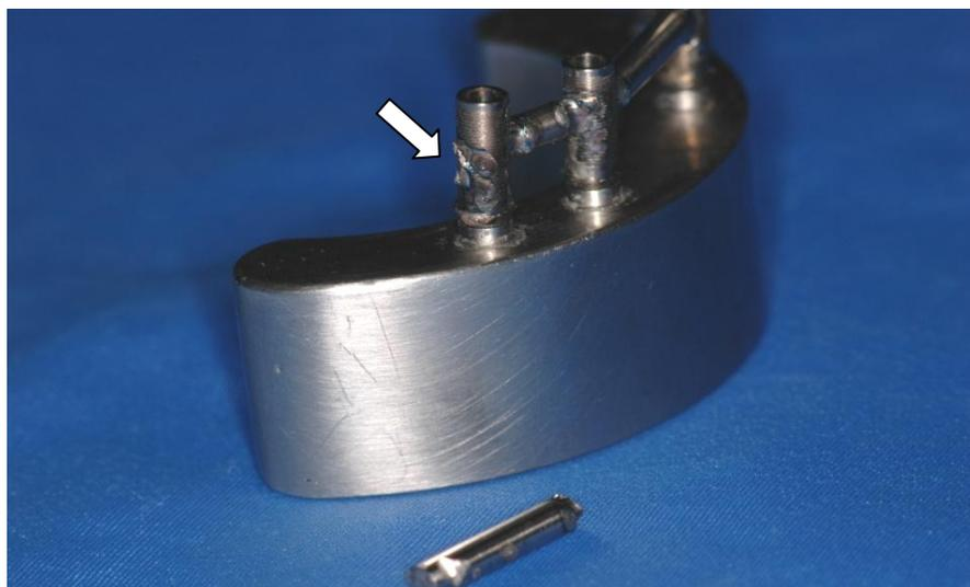
**Figura 45.** Fratura total da região soldada com solda TIG.
