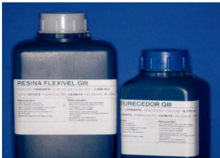
**Figura 28.** Resina fotoelástica flexível (base e endurecedor).
