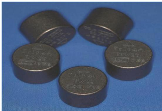
**Figura 14.** Pastilhas de titânio comercialmente puro usadas para a fundição.
