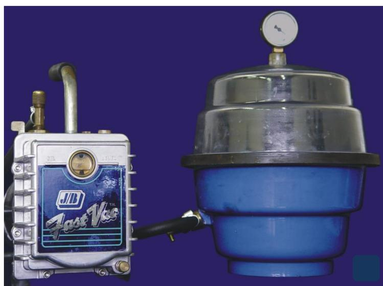
**Figura 29.** Câmara à vácuo.
