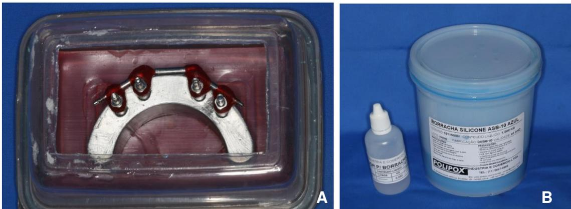
**Figura 25A e B.** (A) Matriz metálica em recipiente para moldagem; (B) Material de moldagem.
