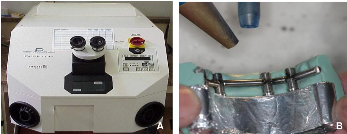
**Figura 19A e B.** (A) Máquina de solda a Laser; (B) Corpo de prova no interior da máquina de solda.
