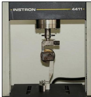
Figura 25: Estrutura posicionada na máquina de ensaio mecânico.
