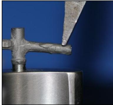
Figura 26: Cinzel posicionado no entalhe confeccionado na estrutura.
