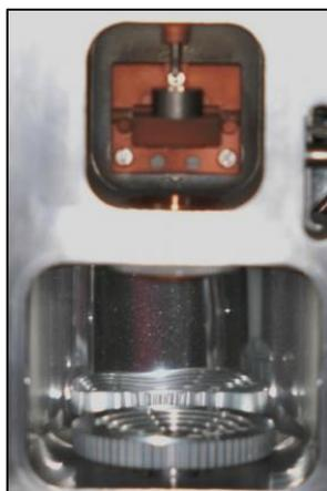
Figura 8 - Câmaras superior e inferior da máquina fundição Discovery Plasma (EDG, São Carlos – SP).
