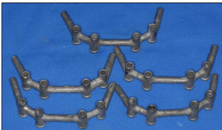
Figura 9 – Estruturas em monobloco obtidas.
