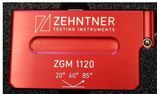
Figura 6 – Medidor de brilho ZGM 1120 GLOSSMETER.
