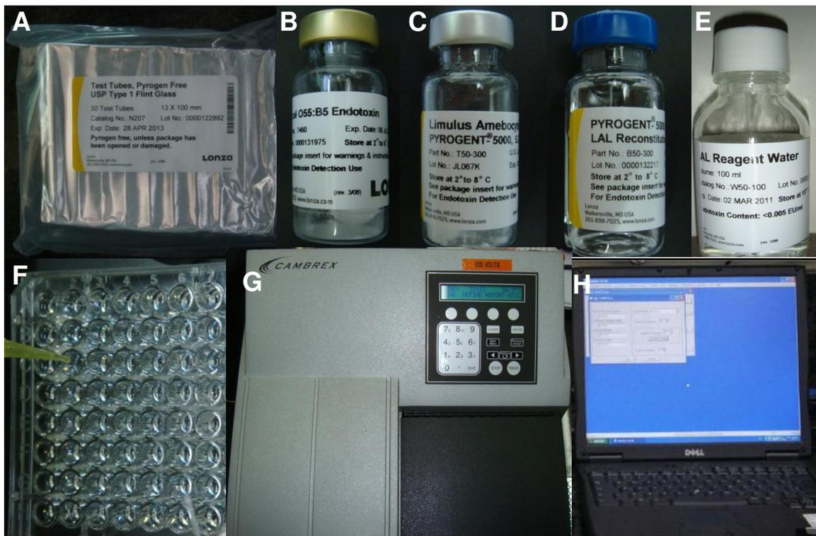
**Figura 7. Teste LAL Pyrogen-5000:** **A** – Tubos de ensaio apirogênicos para preparo da curva padrão, **B** – Endotoxina *E. coli* 055:B5, **C** – Reagente Pyrogen-5000 LAL, **D** – Tampão de reconstituição Pyrogen-5000 LAL, **E** – Água LAL reagente, **F** – Distribuição do reagente Pyrogen-5000 LAL reconstituído na microplaca de 96 poços, **G** – Leitor Biotek (ELX 808, Winooski, VT, EUA), **H** – Software WinKQCL (Lonza, Walkersville, MD, EUA).
