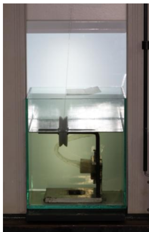
Figura 20 – Vista frontal do polariscópio acoplado à máquina de ensaio Instron, durante teste de tração para a análise fotoelástica.
