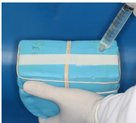
Figura 9– Aplicação da resina fotoelástica no molde.
