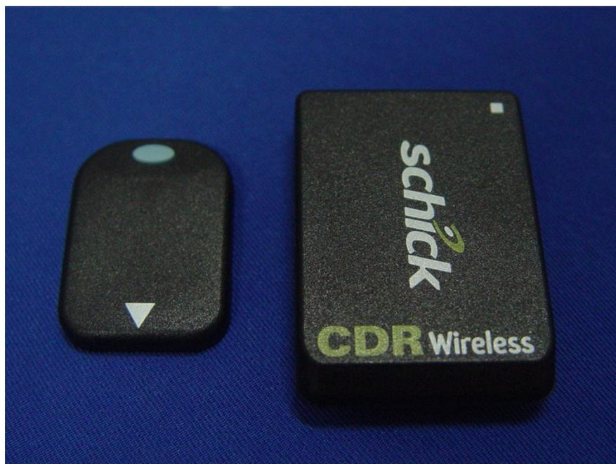
Figura 2 – Sensor CMOS do sistema Schick CDR Wireless<sup>®</sup>, frente e verso.
