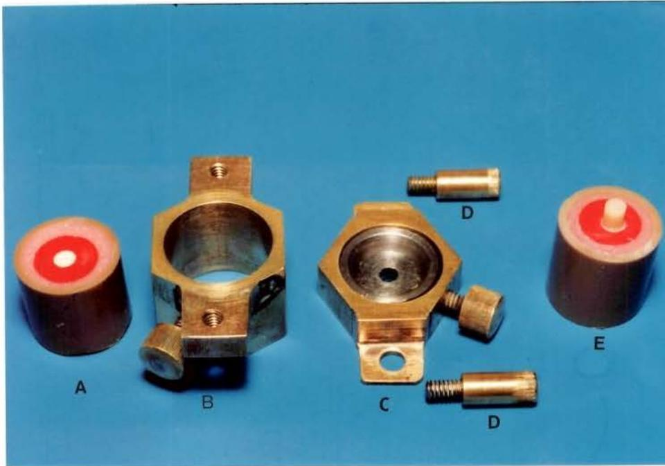
Figura 5 - Disposição seqüencial da amostra e matrizes utilizadas para confecção do corpo de prova. A, amostra; B, matriz usada para posicionar a amostra; C, suporte metálico com a matriz de aço inoxidável no seu interior; D, parafusos de fixação; E, corpo de prova.
