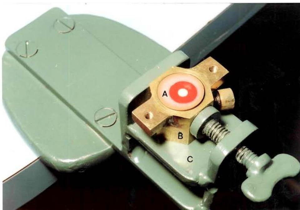
Figura 3 - Corpo de prova posicionado em base metálica fixada a um dispositivo metálico preso à bancada de trabalho. A, corpo de prova; B, base metálica; C, dispositivo metálico
