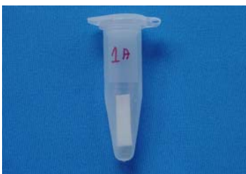
Figura 4 – Wicks embebidos em solução protéica e armazenada a -70^{\circ}\text{C}
