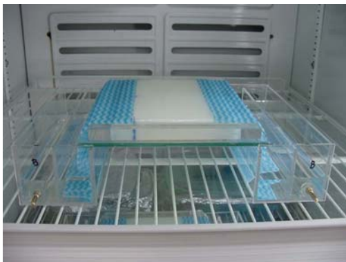
Figura 6 - Sistema de corrida eletroforética para izoenzimas (gel de amido apoiado sobre as cubas e conectado através de ponte de tecidos)
