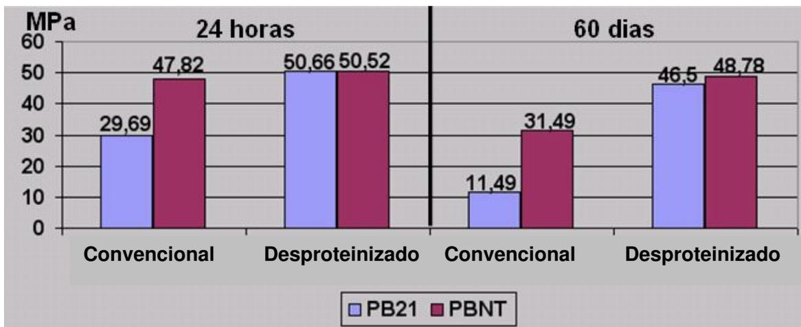
Figura 35 – Representação gráfica da resistência de união à microtração após 24 horas e 60 dias para os grupos não-ciclados.
