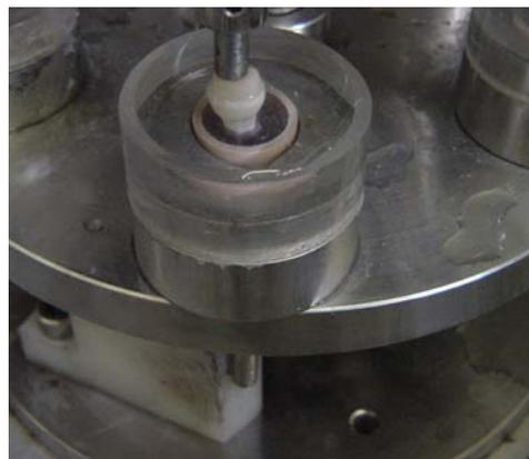
Figura 24 - Amostra na máquina de ciclagem mecânica
