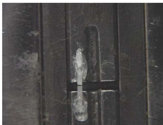
Figura 22 - Fratura do corpo-de-prova após ensaio
