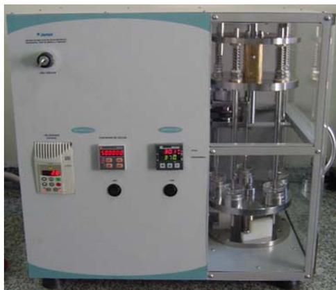
Figura 23 - Máquina para ciclagem mecânica
