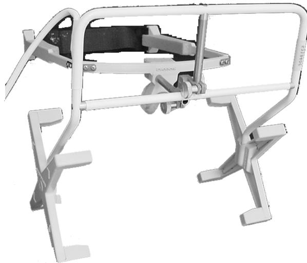
Fig.13- Conexão entre o suporte de fixação na cabeça e os sensores de captação.
