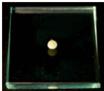
Fig. 7 – Padronização do volume de cimento a ser dispensado entre as placas de vidro.
