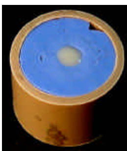
Fig. 7 – Padronização do volume de cimento a ser dispensado entre as placas de vidro.
