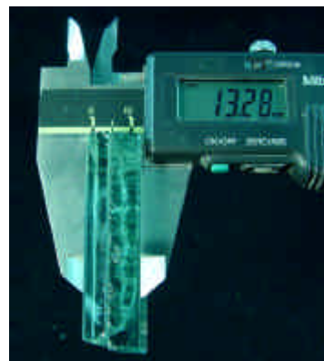
Fig. 6 – Placas de vidro utilizadas para avaliação da espessura de película. Ao lado, mensuração das placas em contato.
