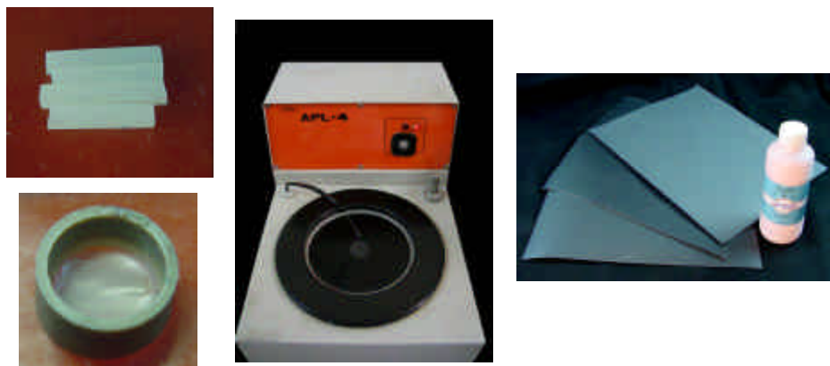
Fig. 9 – Amostras do teste de flexão sendo incluídas em resina epóxi para posterior polimento em politriz automática com lixas d'água (granulação 400, 600 e 1200) e pasta de alumina (0,3 \mu m).
