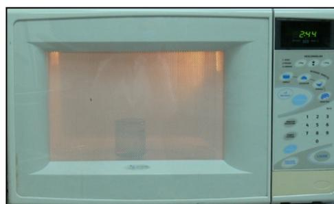
Figura 15 – Irradiação por microondas a 650W por 3 minutos
