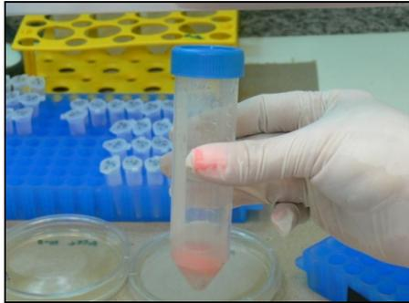
Figura 16 - Corpo-de-prova em tubo com solução salina e pérolas de vidro.
