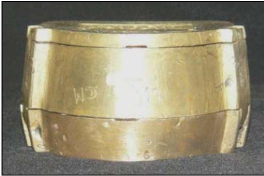
Figura 2 - Mufla metálica.
