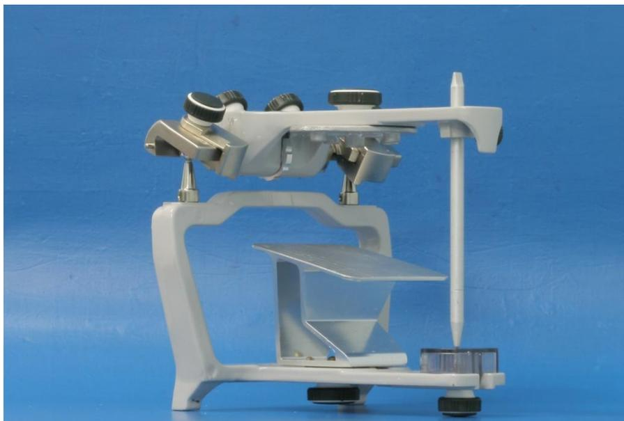
Figura 10 - Plano de camper fixado à porção inferior do articulador
