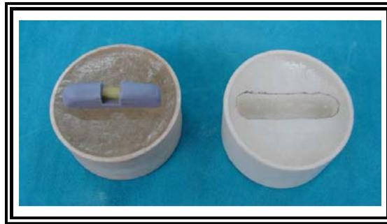
Figura 27: Clipe laboratorial e silicone adaptados à barra e cilindro de PVC com alívio.
