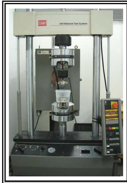
Figura 54: Máquina servohidráulica de ensaios mecânicos – MTS 810.
