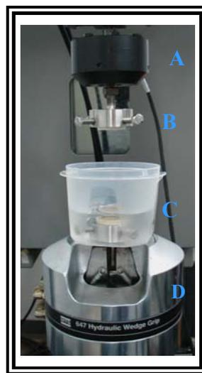
Figura 58: Dispositivos posicionados na máquina MTS: (A) célula de carga; (B) dispositivo metálico; (C) recipiente plástico; e (D) mordente inferior.
