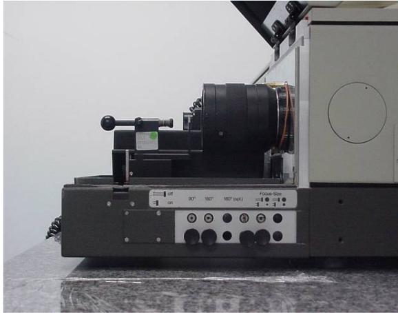
Figura 5 - Espectrômetro FT-Raman
