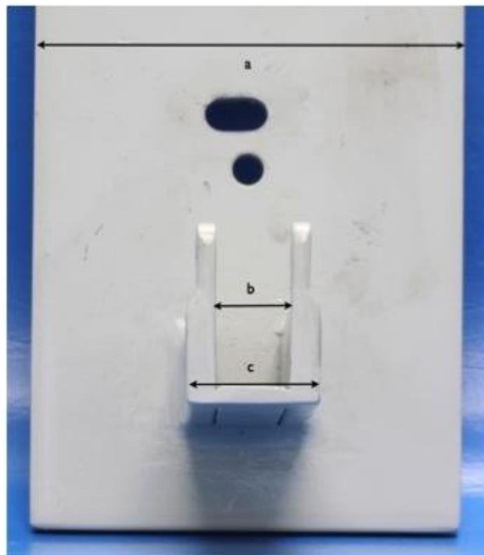
Figura 6. Modelo de suporte usado nos testes mecânicos e respectivas dimensões. Vista lateral, a- 55mm; b- 175mm; c-210mm; d-15mm; e-15mm; f-18mm; g-10mm; h-10mm. Vista superior, a- 145mm; b-23mm; c-40mm.
