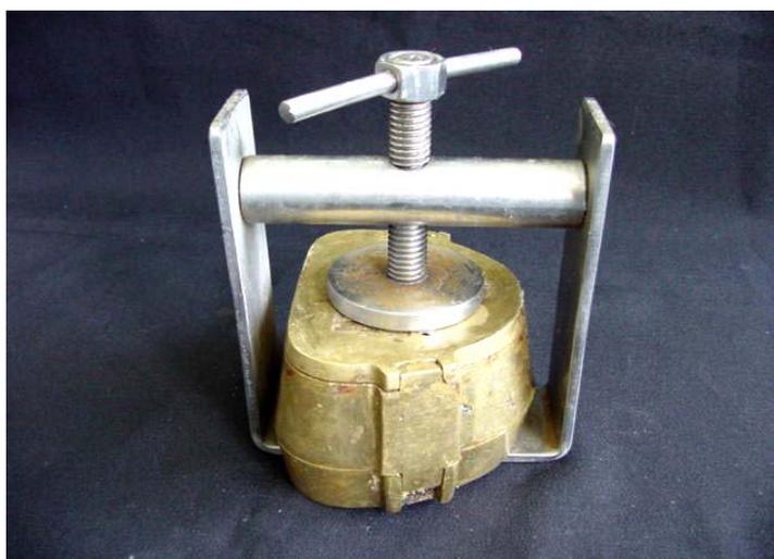
Figura 15 – Mufla metálica fixada com grampo metálico convencional.
