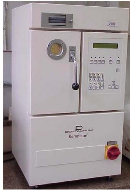
FIG. 3.2. Máquina de fundição (Rematitan).
