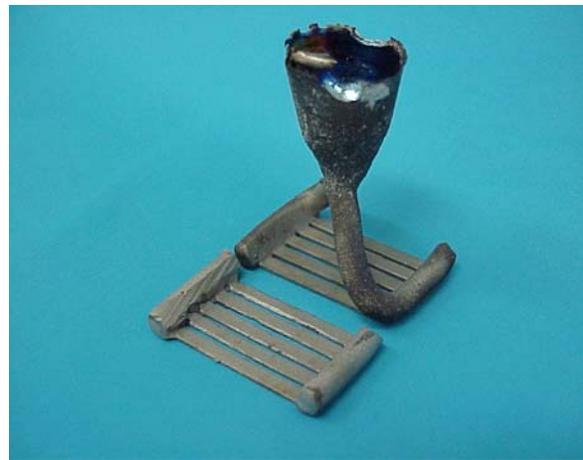
FIG. 3.4. Padrões fundidos, antes e após a remoção parcial dos condutos de alimentação.
