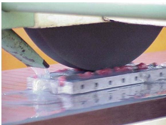
FIG 3.7. Retificação de tira metálica.
