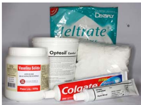
Figura 1. Materiais utilizados na formulação do Optocal (Vaselina Sólida, Gesso Pedra, Alginato, Dentifrício, Silicone Pesado e catalisador)
