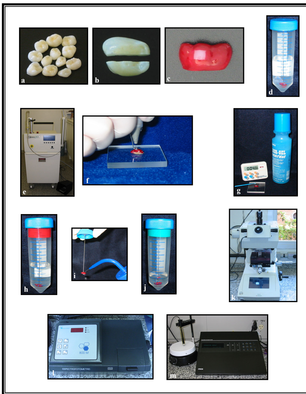
Figura 2. a) Molares decíduos hígidos; b) Secção méso-distal; c) Área de esmalte exposta ( 4 \text{ mm}^2 ); d) Produção de cárie artificial; e) Opus 20 (lasers \text{CO}_2/\text{Er:YAG} ); f) Irradiação do espécime; g) Aplicação de FFA; h) Ciclagem de pH - solução DES; i) Ciclagem de pH - lavagem com água destilada e deionizada; j) Ciclagem de pH - solução RE; k) Microdurômetro para análise de microdureza; l) Espectrofotômetro para análise de fósforo; m) Eletrodo específico e analisador de íons para análise de flúor.
